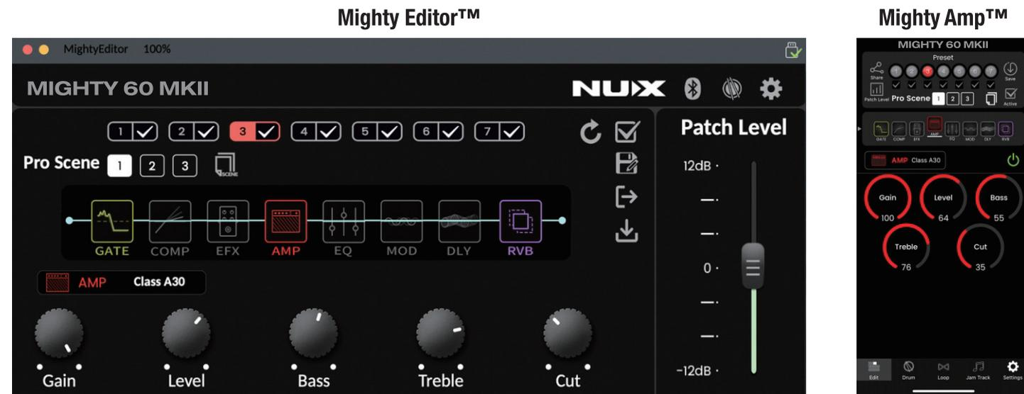
Mit der Mighty Amp™ App und der Mighty Editor™ Software können Sie alle Signalblöcke und Parameter einstellen. Der MIGHTY 60 MKII enthält die Signalblöcke GATE, COMP, EFX, AMP, EQ, MOD, DLV und RVB, die frei angeordnet werden können, um den gewünschten Sound zu erzeugen.
